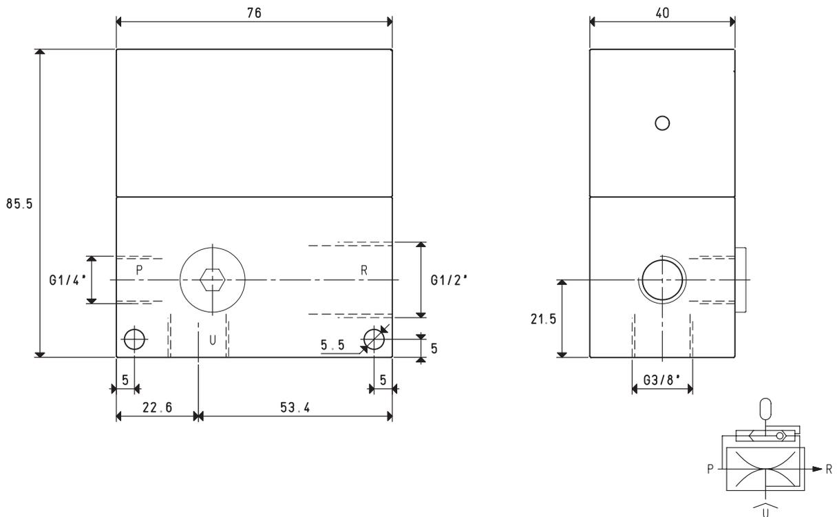
P=CONNESSIONE ARIA COMPRESSA    R=SCARICO    U=CONNESSIONE VUOTO
